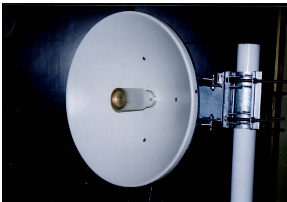
Slika 14. Primarni radijator sa sekundarnim reflektorom nalazi se u centru antene
